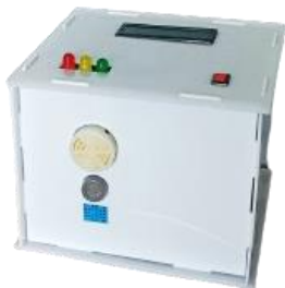
Gambar 5. Alat uji kualitas udara gas co dan suhu
